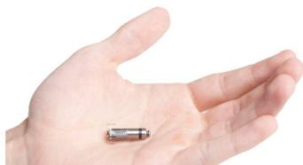
Le tableau 10 présente la distribution des prix pour un mini-stimulateur cardiaque sans sondes, en deux variantes : simple chambre et double chambre. Il est placé à l'intérieur du cœur via un cathéter introduit par une veine fémorale. Un tel modèle couvre environ 50 % des indications de stimulation cardiaque.
